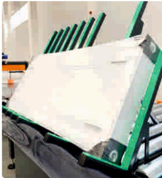
В ассортименте выпускаемой продукции стальные панельные радиаторы различных типов (10, 11, 20, 21, 22, 30, 33), размеров (с высотами 200 мм, 300 мм, 400 мм, 500 мм, 600 мм, с длиной от 400 мм до 3 000 мм). Радиаторы выпускаются в стандартном и гигиеническом исполнении с различным типом подключения (боковым/нижним).
